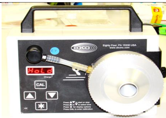
پمپ نمونه برداری محیطی Quick Take 30
