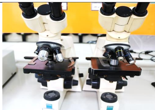
میکروسکوپ نوری کاربرد: شمارش گردوغبار و نمونه های میکروبی
