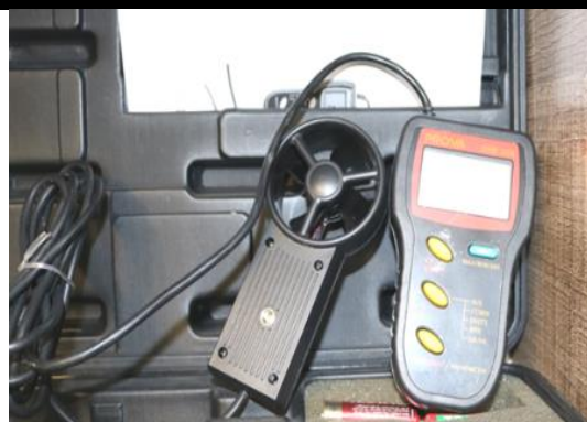
آنومتر پره ای PROVA – AVM305
