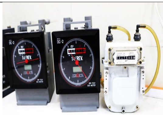
گازمتر خشک کاربرد: کالیبراسیون ثانویه
