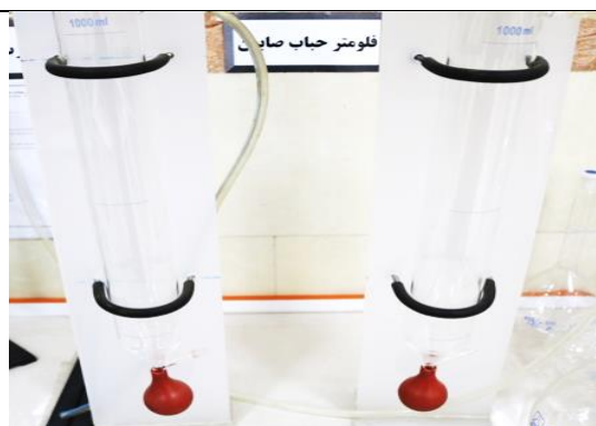
فلومتر حباب صابون کاربرد: کالیبراسیون اولیه
